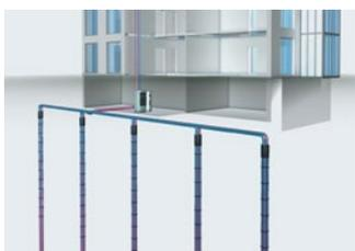
En cuanto al principio de funcionamiento, el sistema se compone de una serie de captadores integrados en el terreno por los que circula un líquido (normalmente agua con glicol), conectados a una bomba de calor agua-agua que alimenta a su vez a los elementos terminales situados en el interior del edificio. En función de la estación del año y por tanto de las necesidades en el edificio, el calor irá desde el terreno al interior del mismo o desde el interior del edificio al terreno.
