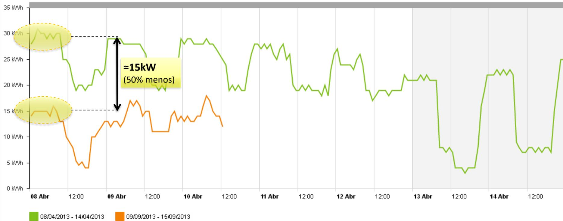
**REDUCCIÓN EN LA POTENCIA CONSUMIDA DE EN TORNO A 15kW (≈50%), SUPERIOR A LA REDUCCIÓN ESTIMADA EN PROYECTO (≈37%)**
